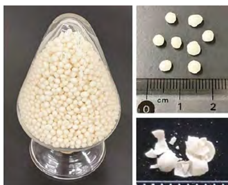
開発品の被覆肥料と被覆殻の崩壊の様子
