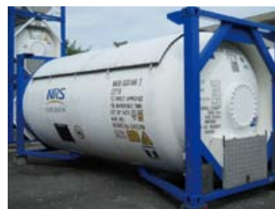
HFO-1233zd(E) ISOタンクコンテナ (株式会社日陸の協力により掲載)
