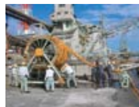
展張訓練後のオイルフェンス巻取り作業
